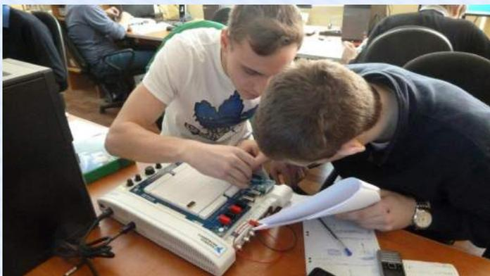
Студентам предлагается собрать на макетной плате простейший модулятор, каждому выдаётся индивидуальное задание – продемонстрировать один из видов модуляции, сделать сигнал «невидимым» или устранить помехи. Затем следует демонстрация результатов лабораторных работ: один изменил свой голос до неузнаваемости, другой довёл его до совершенства, сделал оперным, третий размножил до хорошего
